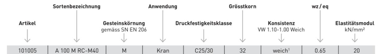
**M:** Mischgranulat      **M/N:** Mischung aus Mischgranulat und Natursteine      **RC-M40:** 40 M.-% < M < 100 M.-% in Massenprozent
