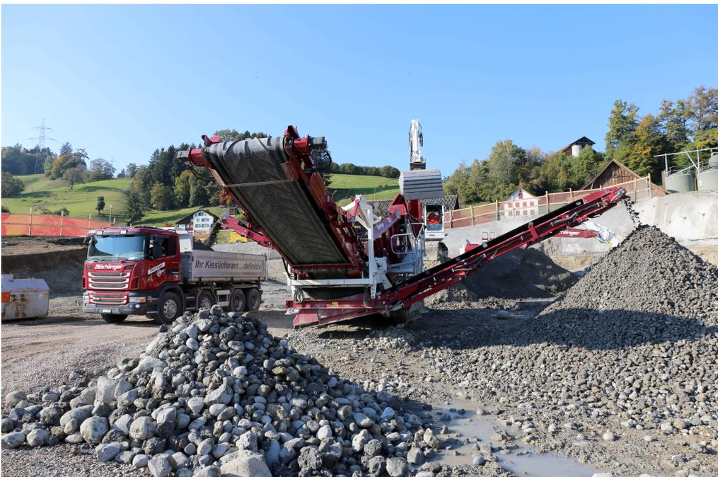
Foto 2, Mobile Siebmaschine
